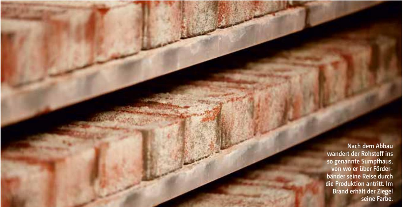
Nach dem Abbau wandert der Rohstoff ins so genannte Sumpfhaus, von wo er über Förderbänder seine Reise durch die Produktion antritt. Im Brand erhält der Ziegel seine Farbe.
